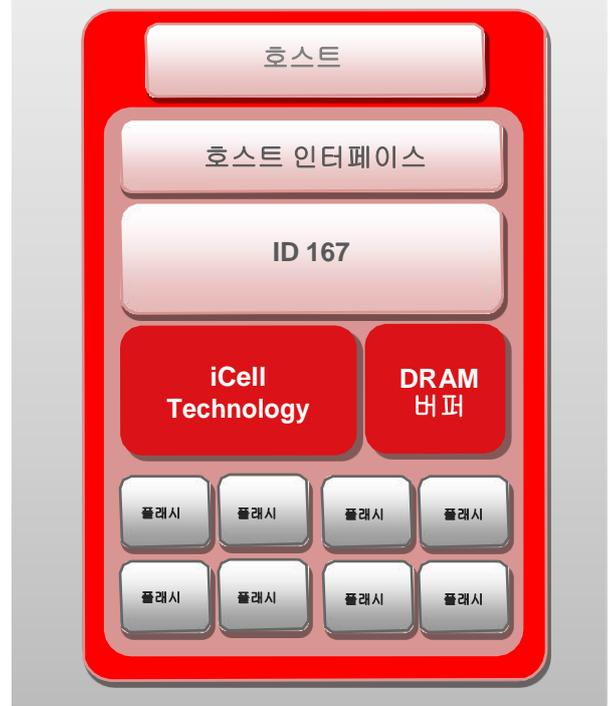
iCell Technology는 비정상적인 전원 공급 중단이 발생하는 경우 갑작스러운 전원 공급 차단에 의한 전압 저하를 감지해 SSD 컨트롤러에 피드백을 보낼 수 있습니다. SSD 컨트롤러가 이 피드백 신호를 받으면 SSD 펌웨어가 해당 데이터를 플래시 스토리지 저장하는 절차가 개시됩니다. 그 결과, iCell은 정전 중 전력을 공급해 일체의 데이터 손실을 막아 줍니다.
