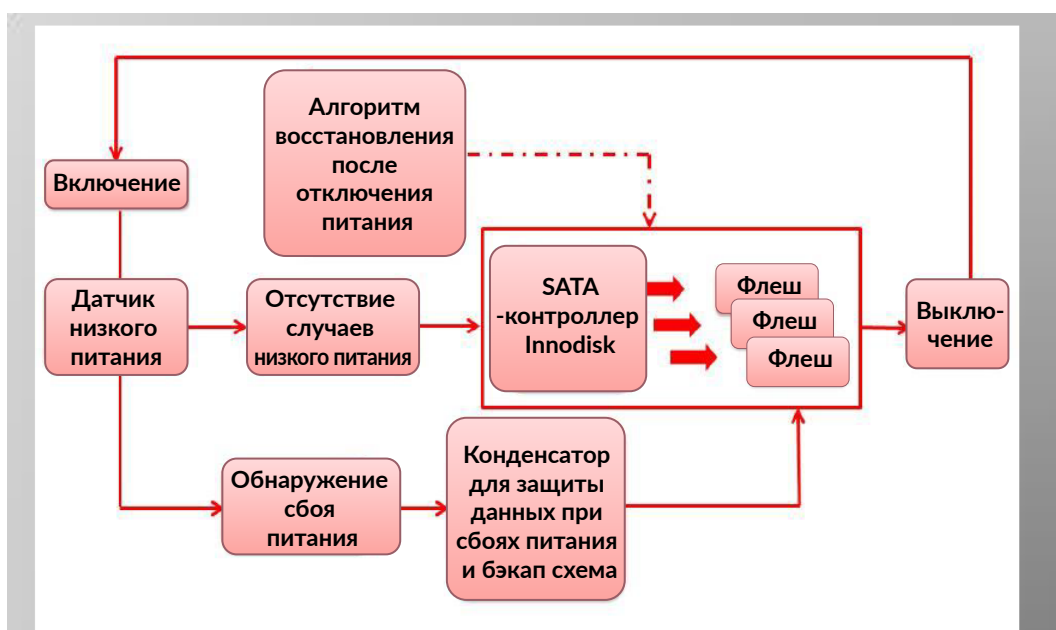
Рисунок 1: Блок-схема сохранения данных SSD-накопителей Innodisk при сбоях питания
