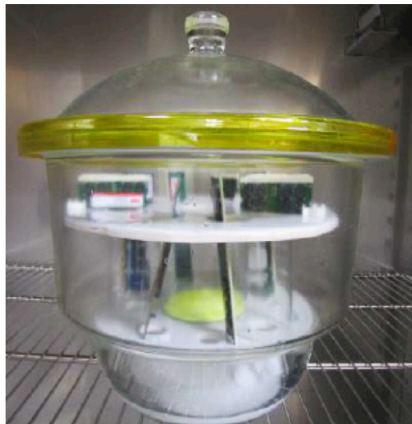
그림 2: 항황화 저항기를 탑재한 DRAM 모듈의 테스트
